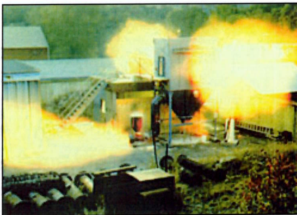
Figura 2. Explosão em moega provocada por poeira.
